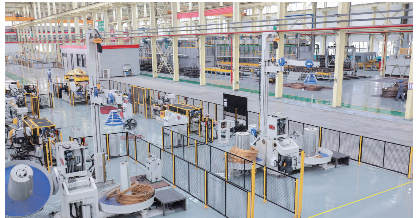
铜及铜合金2.5吨EJP联合拉拔机生产线
