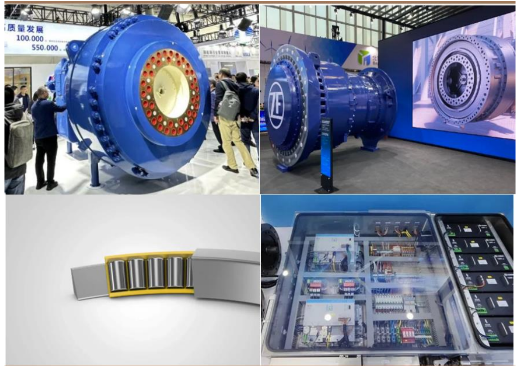
图 5: 南高齿 9-10MW 双馈型主齿轮箱/采埃孚集成式中速齿轮箱/利勃海尔单列圆锥滚子轴承/国能信控风电变桨
