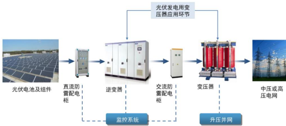
图 16：光伏发电用变压器应用环节
