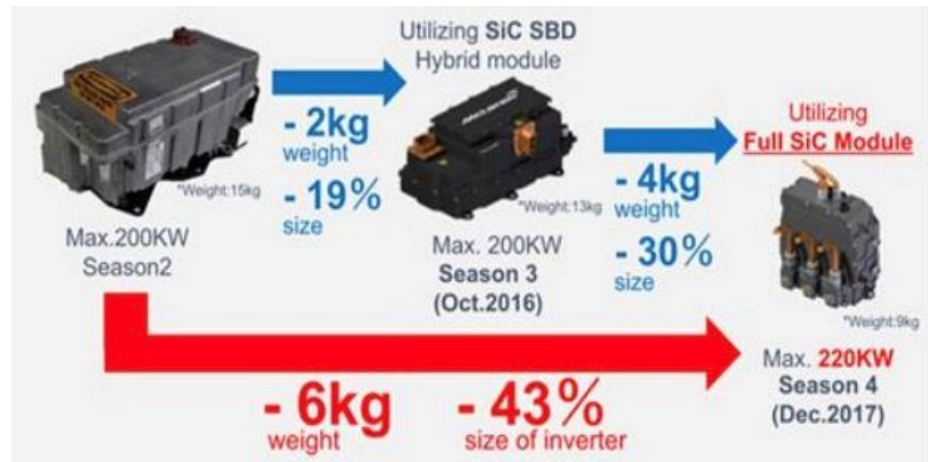
图32.SiC 使用明显降低逆变器尺寸
